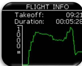
Durante il volo, le statistiche del volo sono riportate nella pagina statistiche. Sulla parte superiore sono visualizzate l'orario di decollo (Take-off) e il tempo trascorso fino a quel momento, mentre nella parte inferiore è rappresentato il diagramma barografico delle quote dell'ultima ora di volo.
