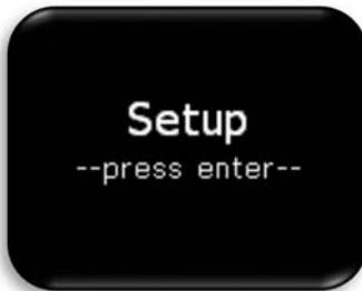
Selezionata la pagina Setup con il selettore rotativo, per entrare nelle opzioni di configurazione, premere invio. Tutte le opzioni di setup verranno visualizzati in un elenco. Utilizzare selettore rotativo per selezionare la voce di interesse.
