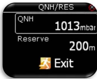
In questo menù il pilota imposta il QNH reale e l'elevazione dell'aeroporto di decollo sulla schermata di impostazione iniziale. Con il cambio di QNH durante il volo, il pilota modifica le informazioni di altitudine con le quali sarà calcolata la planata finale. Se il QNH viene modificato solo a terra, altitudine non sarà corretta e sarà ancora la stessa impostata nella configurazione iniziale.
