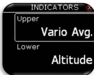
Il pilota può selezionare le indicazioni numeriche superiore (**Upper**) ed inferiore (**Lower**) del display nella pagina principale del variometro.
