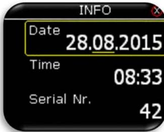
Nel menù **INFO** il Pilota può impostare la data e l'ora correnti. Se è collegato una qualsiasi fonte di dati GPS, data e ora verranno impostate automaticamente. Data e ora devono essere impostati su UTC.
