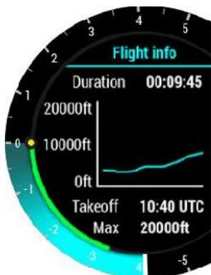
Während des Fluges werden auf dieser Seite Statistiken zum Flug angezeigt. Die Startzeit wird unten auf der Seite und die Flugdauer oben angezeigt. Eine Balkenlinie zeigt die Flughöhe für die letzte Stunde. Durch Drücken der Eingabetaste auf dieser Seite hat der Pilot die Möglichkeit, den Flug bei Bedarf sofort zu beenden.
