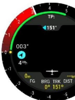
LX Era in der LX Zeus-Konfiguration verwendet wird, wird die unter WP / Task / Era-Liste auf dem LX Zeus ausgewählte TP-Datenbank automatisch übertragen (unbegrenzte Anzahl von TPs). TP wird als weißer Punkt mit einem "W" in der Mitte (Wegpunkt) angezeigt. Navigation ist immer "nach oben".
