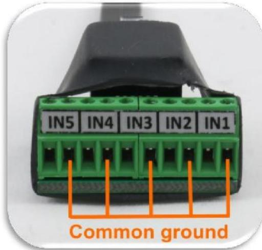
Bis zu fünf externe Schalter können an LX ERA angeschlossen werden. Um einen externen Schalter mit LX ERA zu verbinden müssen Sie die externe Schalter-Schnittstellenkarte verwenden (im Lieferumfang enthalten). Jeder Steckplatz hat einen Signal- und Masse-Eingang. Die Konfiguration der Eingänge können unter <Einrichtung> eingestellt werden Setup-> Eingänge.
