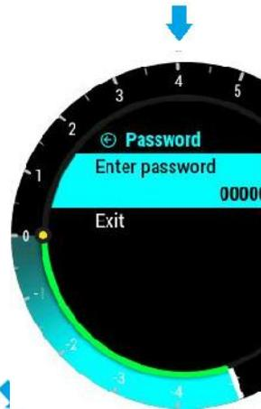
Nach Eingabe des Codes wird der Aktualisierungsvorgang gestartet. LX Era meldet einen Fehler, wenn der Code nicht korrekt ist. Das Update kann bis zu 4 Minuten dauern. Das Gerät wird nach einem erfolgreichen Update automatisch neu gestartet. LX Era aktualisiert auch alle an das System angeschlossenen LX CAN-Geräte.
