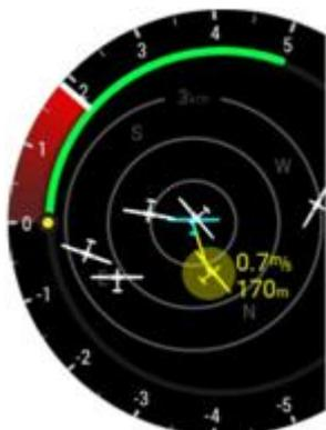
Um ein neues Flarm-Objekt auszuwählen, drücken Sie auf der Flarm-Radarseite die Eingabetaste und verwenden Sie die Option „Auswählen“. Um das ausgewählte Flarm-Objekt wird ein undurchsichtiger gelber Kreis angezeigt, der darauf hinweist, dass Sie sich im Auswahlmodus befinden.
