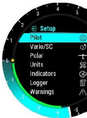
Der Pilot kann entweder einen Piloten auswählen, der bereits in der Datenbank gespeichert ist, oder „LEER“ auswählen, um einen neuen Piloten zu erstellen. Wenn ein Pilot bereits gespeichert ist, werden Vor- und Nachname angezeigt. Der Name des Piloten oder "LEER" wird automatisch in der zweiten Zeile angezeigt. Die Codeeingabe ist erforderlich, wenn der ausgewählte Benutzer sein Profil mit Benutzer-code geschützt hat.
