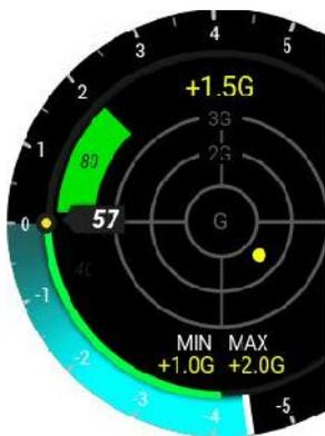
Die G-Kraft-Seite besteht aus einer kreisförmigen Skala, die die verschiedenen Beschleunigungswerte darstellt, und einem gelben Punkt, der sich entsprechend der aktuellen resultierenden Kraft bewegt. Am unteren Rand des Displays werden die maximale und minimale G-Kraft angezeigt.
