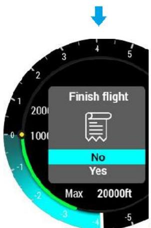
Wenn die Option "Ja" ausgewählt ist, wird die Meldung "Sicherheit berechnen" angezeigt. Der Flug wird gespeichert.
