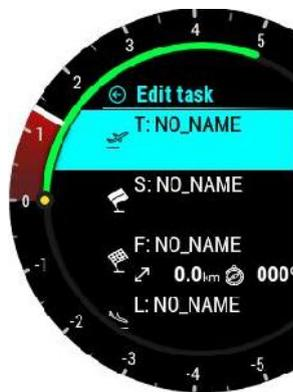
Durch Drücken der Eingabetaste wird "TSK SETUP" aktiviert, sodass eine Aufgabe erstellt oder bearbeitet werden kann. Zusätzliche TPs können hinzugefügt, entfernt oder die Zonen usw. geändert werden.
