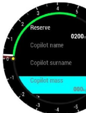
„Reserve“ ist die Sicherheits-Ankunftshöhe, die das Gerät zu der benötigten Endanflughöhe hinzufügt, sodass das Segelflugzeug oberhalb des anvisierten Zieles mit der eingegebenen Reservehöhe ankommt.
